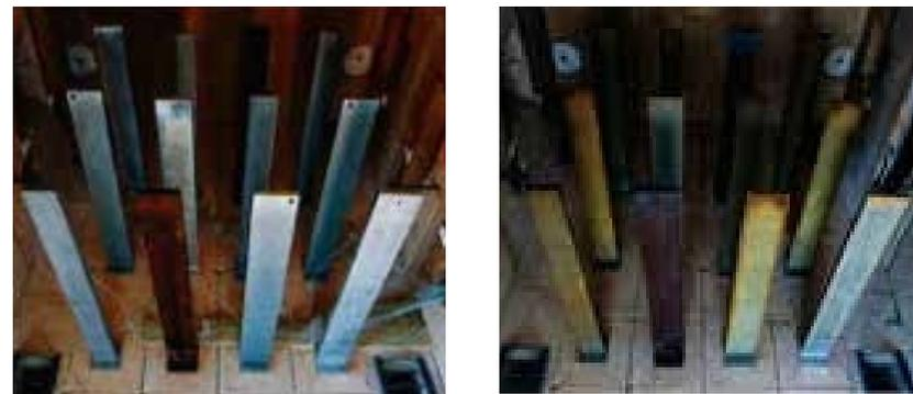
Vergleich der Proben vor (links) und nach (rechts) dem zweiten Brandversuch.
