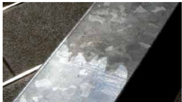
Mit GalvaSeal behandelte Teile erhalten den Glanz (unten GalvaSeal, oben unbehandelt nach 15 Monaten in der Witterung)
